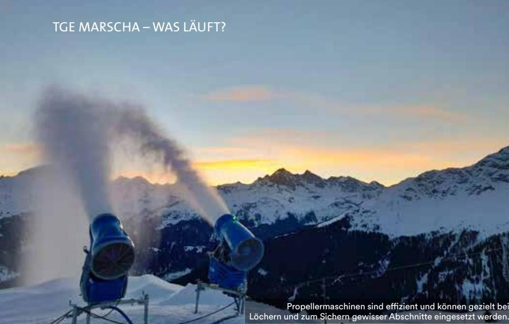
Propellermaschinen sind effizient und können gezielt bei Löchern und zum Sichern gewisser Abschnitte eingesetzt werden.
